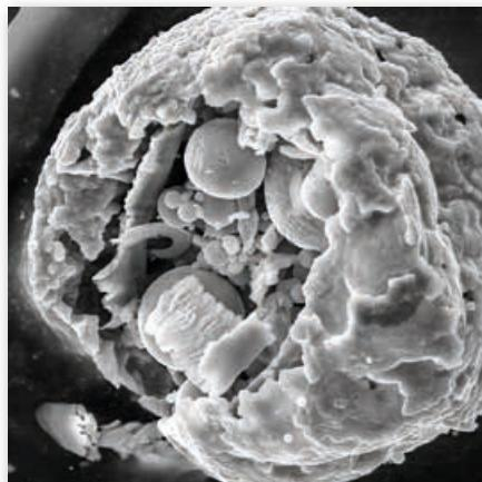
Částice oceli uvolněná při broušení;
