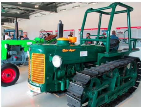
Staříčský Zetor Super 50 s pásovou úpravou do bahňitého terénu z roku 1960, foto: autor
